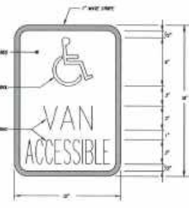
"VAN ACCESSIBLE" SIGN DETAIL N.T.S.
