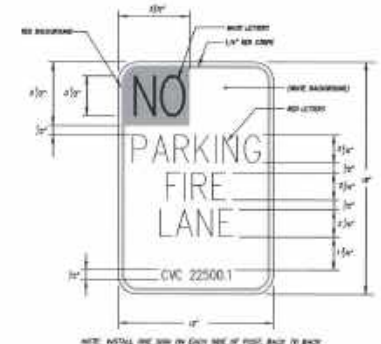
"FIRE LANE" SIGN DETAIL N.T.S.
