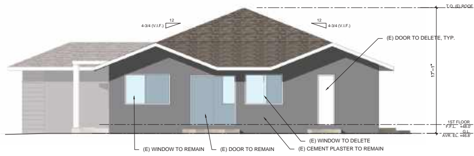
2 RIGHT ELEVATION (EXISTING) S. 1/4"=1'-0"
